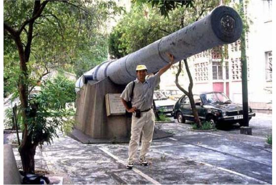
路乍砲台。大炮全長30呎，炮口直徑10吋，炮管末端直徑四呎。大炮是由後膛裝彈，發射炮彈每秒可達2100呎初速，能於一千碼距離射穿廿一又五分一吋厚生鐵板。1913年間，由於砲台已失去防衛的功效，卑路乍砲台遭棄置，此巨炮亦被拆毀，僅餘炮管，但其重量亦有32噸。
