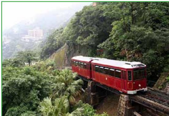
第五代山頂纜車，1989年引入現代化科技，提升原有動力系統由電腦控制電子驅動，並提高載客量至每車120人。
